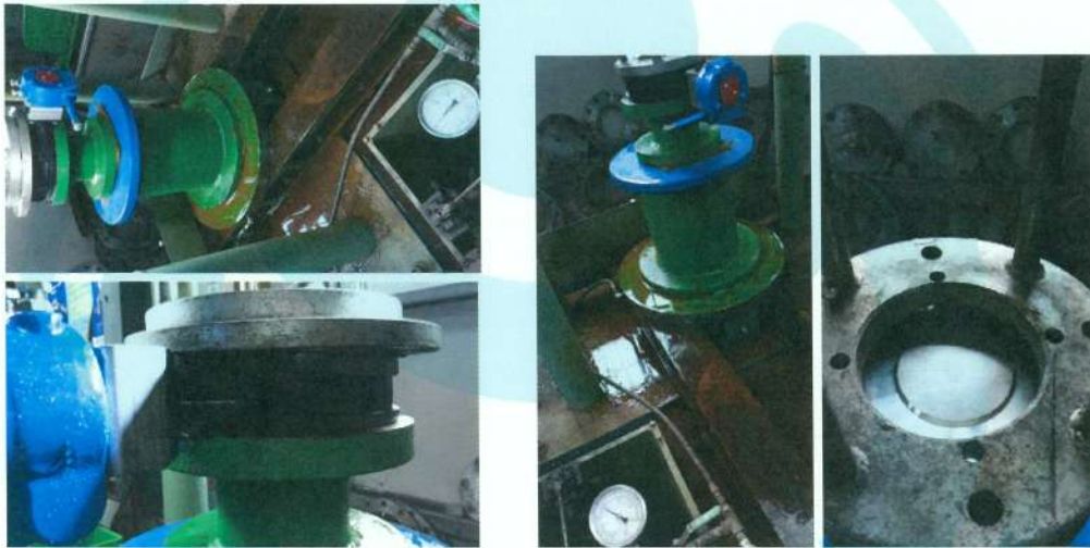
照片 44 延性鑄鐵偏心蝶閥 16K (D55 6 吋) 閥體及閥座試驗實況
