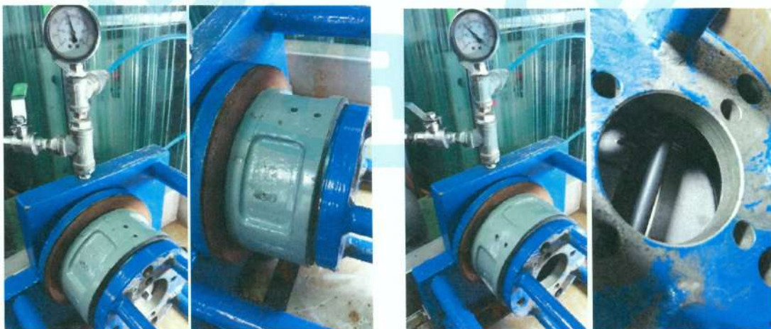
照片 39 鑄鐵雙瓣逆止閥 10K (F38 4吋) 閥體及閥座試驗實況
