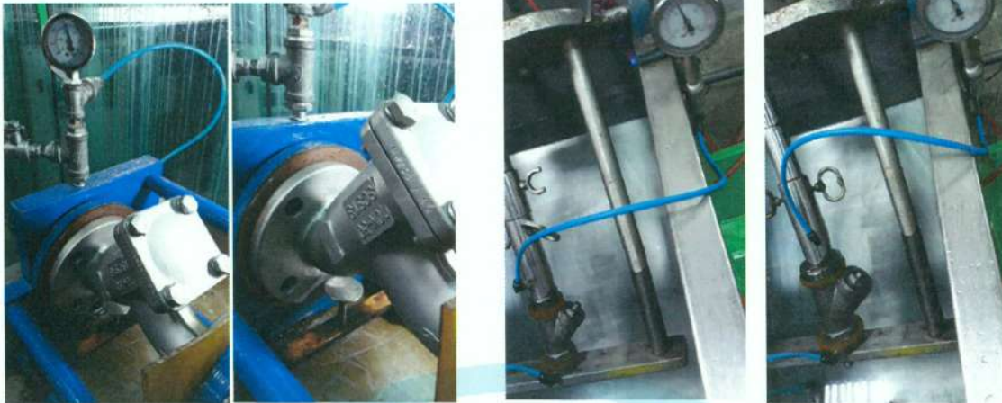
照片 7 法蘭口不銹鋼 Y 型過濾器 (S42 2 吋)閥體試驗實況(左) 螺紋口不銹鋼 Y 型過濾器 (S41 1 吋及 1-1/2 吋)閥體試驗實況(右)
