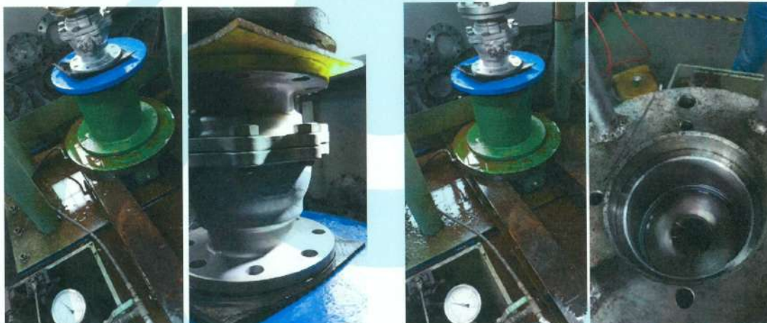
照片 20 法蘭口不銹鋼球閥 10K (S25 4 吋) 閥體及閥座試驗實況
