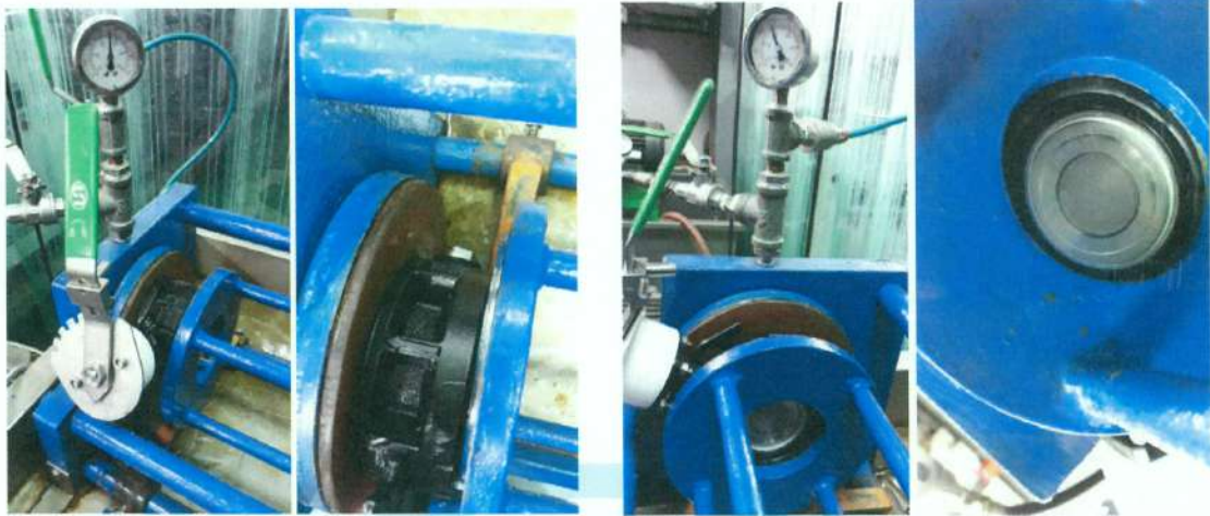
照片 43 延性鑄鐵偏心蝶閥 16K (D55 2-1/2 吋) 閥體及閥座試驗實況
