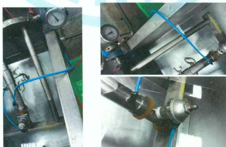
照片 54 砲金銅減壓閥及組 (B61 1吋) 閥體試驗實況(左) 螺紋口水錘吸收器 (S81 3/4吋) 閥體試驗實況(右)
