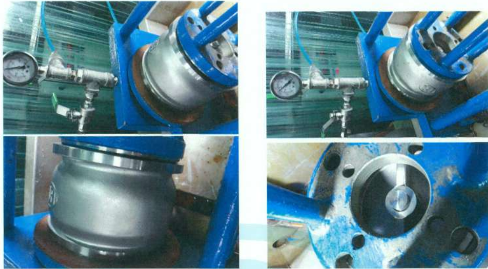
照片 13 夾式不銹鋼緩衝逆止閥 10K (S37 4吋) 閥體及閥座試驗實況
