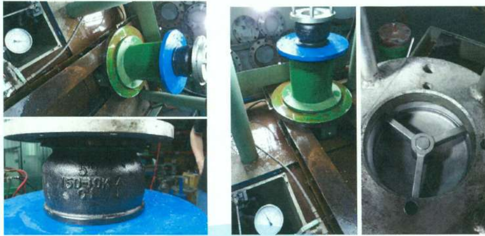
照片 37 夾式鑄鐵緩衝逆止閥 10K (F37 5吋) 閥體及閥座試驗實況
