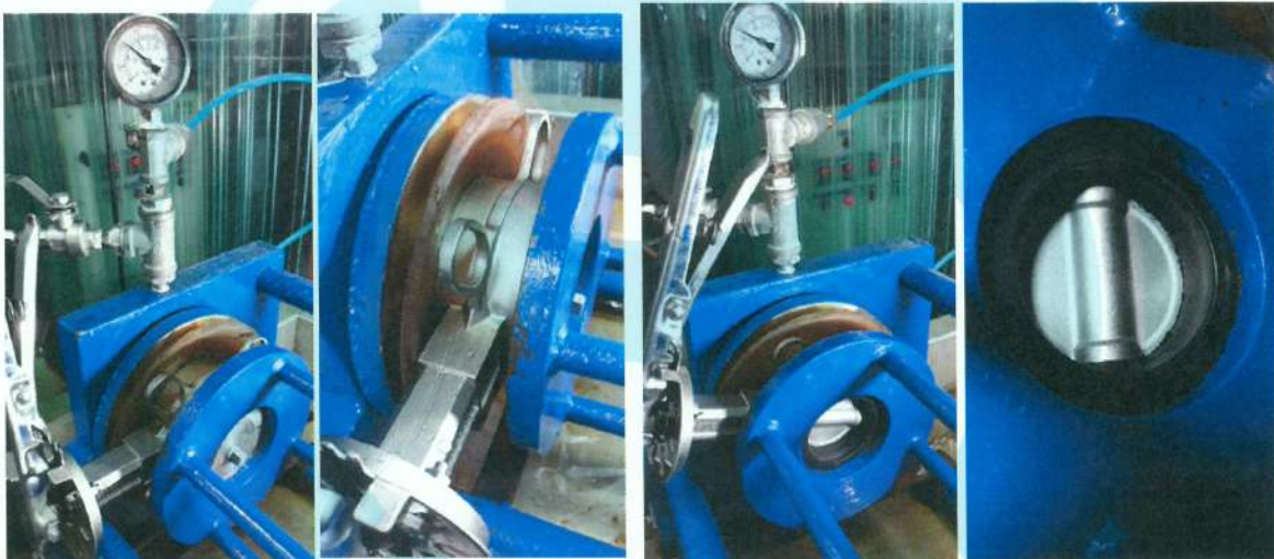
照片 8 夾式不銹鋼蝶閥 10K (S52 2-1/2 吋) 閥體及閥座試驗實況
