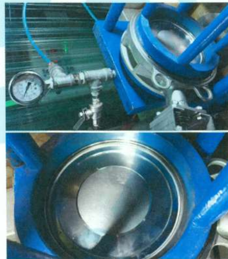
照片 11 不銹鋼偏心蝶閥 10K (S54 6 吋) 閥體及閥座試驗實況
