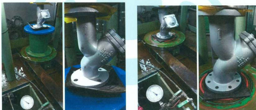
照片 32 法蘭口鑄鐵 Y 型過濾器 10K (F42 2 吋及 4 吋) 閥體試驗實況
