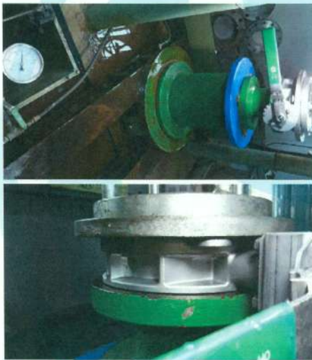
照片 11 不銹鋼偏心蝶閥 10K (S54 6 吋) 閥體及閥座試驗實況
