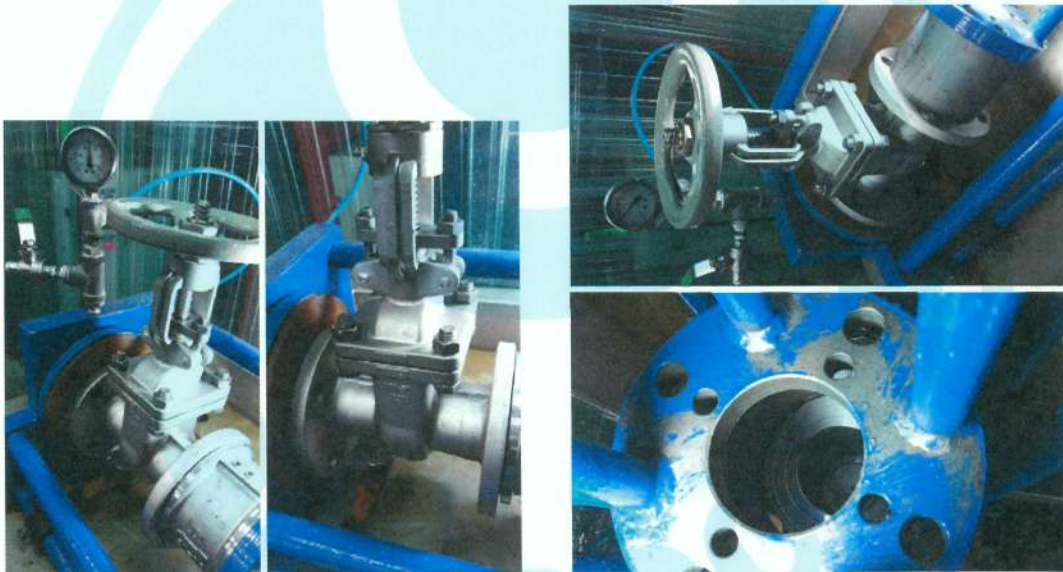
照片 2 法蘭口不銹鋼閘閥 10K (S07 2吋) 閥體及閥座試驗實況
