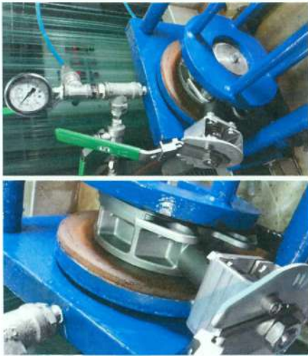
照片 10 不銹鋼偏心蝶閥 10K (S54 3 吋) 閥體及閥座試驗實況
