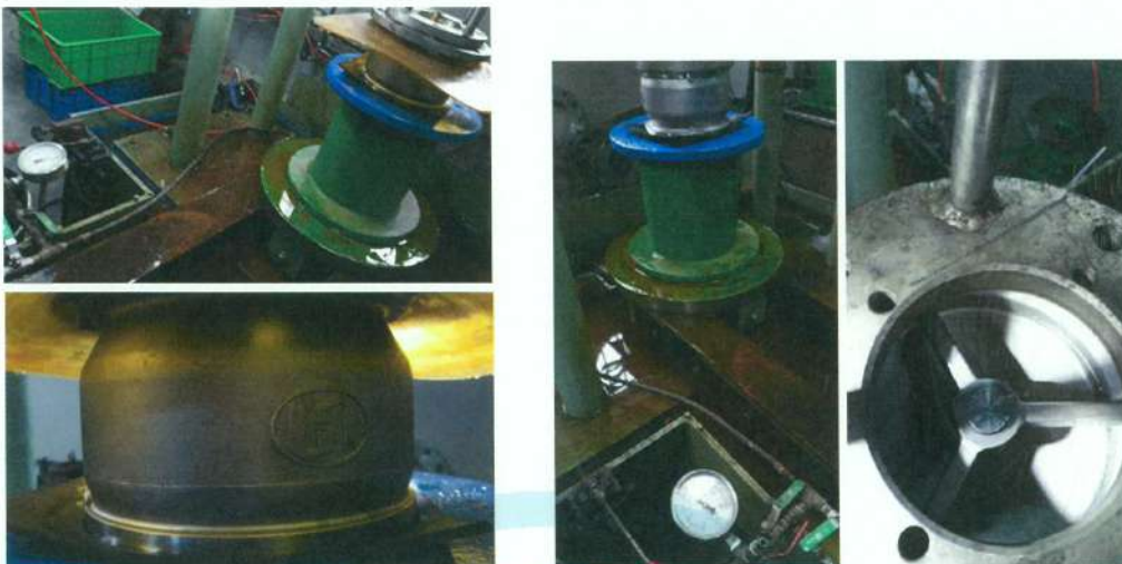
照片 16 夾式不銹鋼緩衝逆止閥 10K (S39 6吋) 閥體及閥座試驗實況
