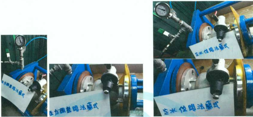
照片 52 法蘭口壓力調整閥 10K (S66 2吋) 閥體及閥座試驗實況(左) 法蘭口定水位閥 10K (S68 2吋) 閥體及閥座試驗實況(右)
