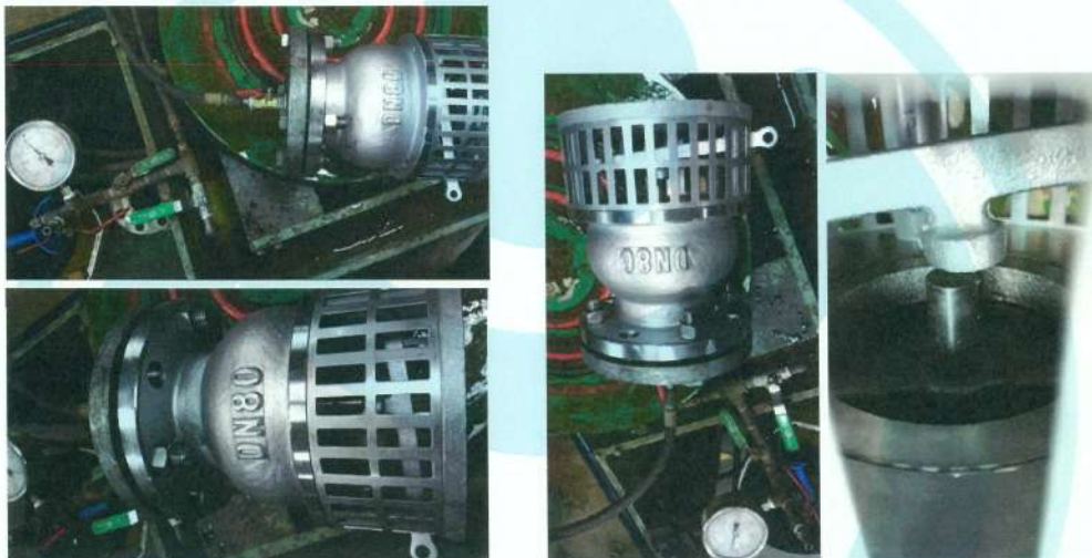
照片 23 法蘭口不銹鋼底閥 10K (S30 3吋) 閥體及閥座試驗實況
