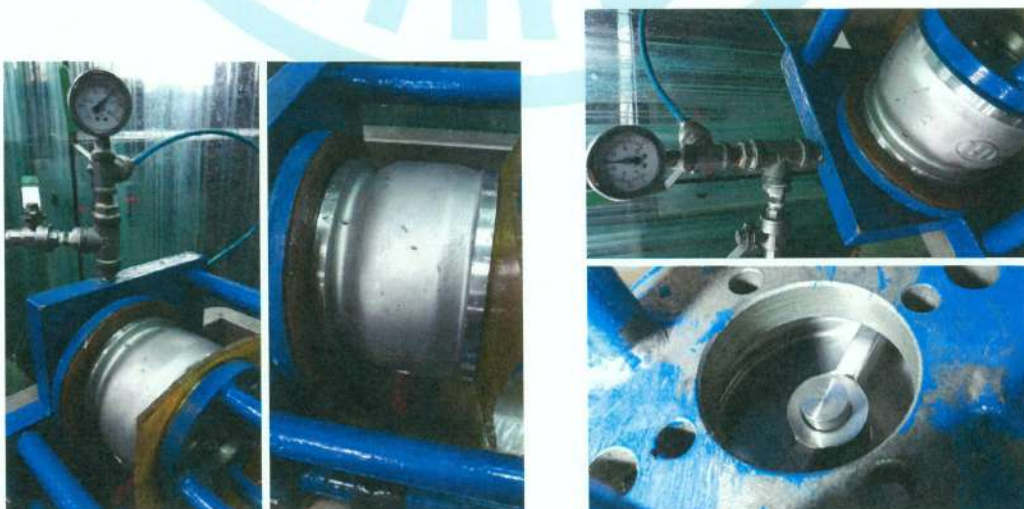
照片 15 夾式不銹鋼緩衝逆止閥 16K (S39 4吋) 閥體及閥座試驗實況
