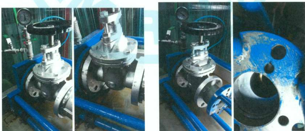
照片 24 法蘭口鑄鐵閘閥 10K (F05 2吋) 閥體及閥座試驗實況
