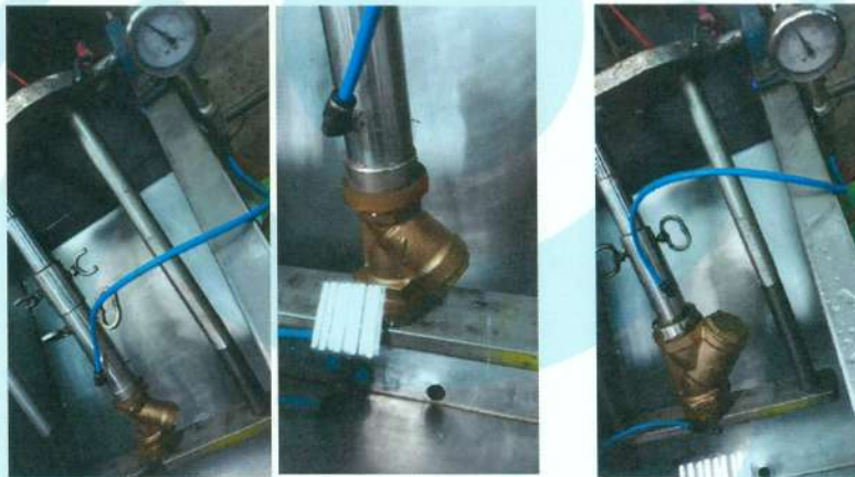
照片 50 青銅 Y 型過濾器 (B41 1吋及2吋) 閥體試驗實況
