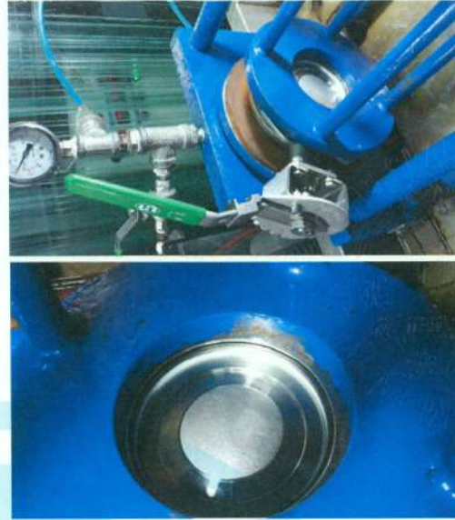
照片 10 不銹鋼偏心蝶閥 10K (S54 3 吋) 閥體及閥座試驗實況
