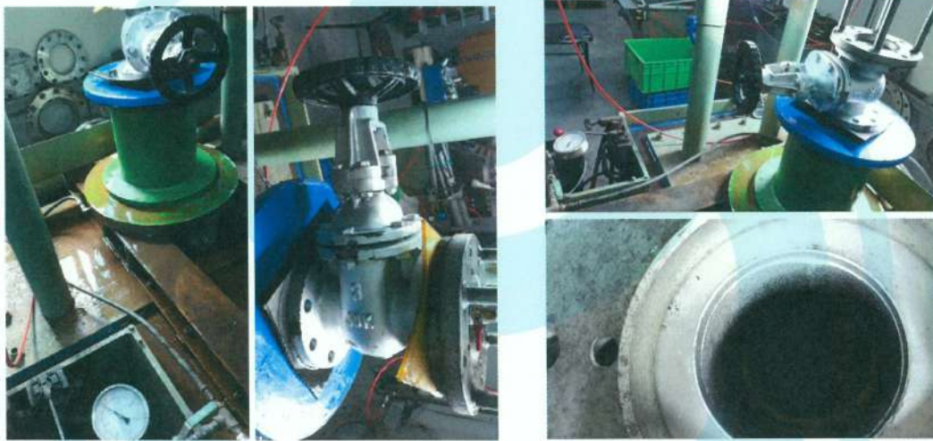
照片 26 法蘭口鑄鐵昇桿閘閥 (F07 3吋) 閥體及閥座試驗實況
