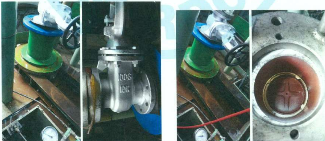
照片 27 法蘭口鑄鐵昇桿閘閥 (F07 4吋) 閥體及閥座試驗實況
