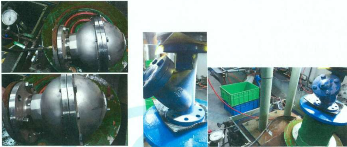
照片 55 法蘭口水錘吸收器 (S82 3 吋) 閥體試驗實況(左) 延性鑄鐵 Y 型過濾器 (D43 2-1/2 吋) 閥體試驗實況(右)
