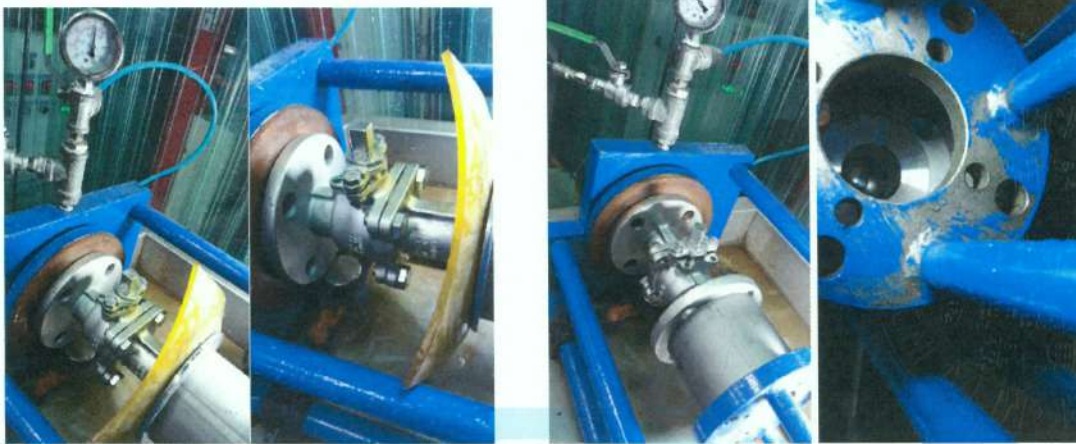
照片 19 法蘭口不銹鋼球閥 10K (S25 1/2 吋) 閥體及閥座試驗實況
