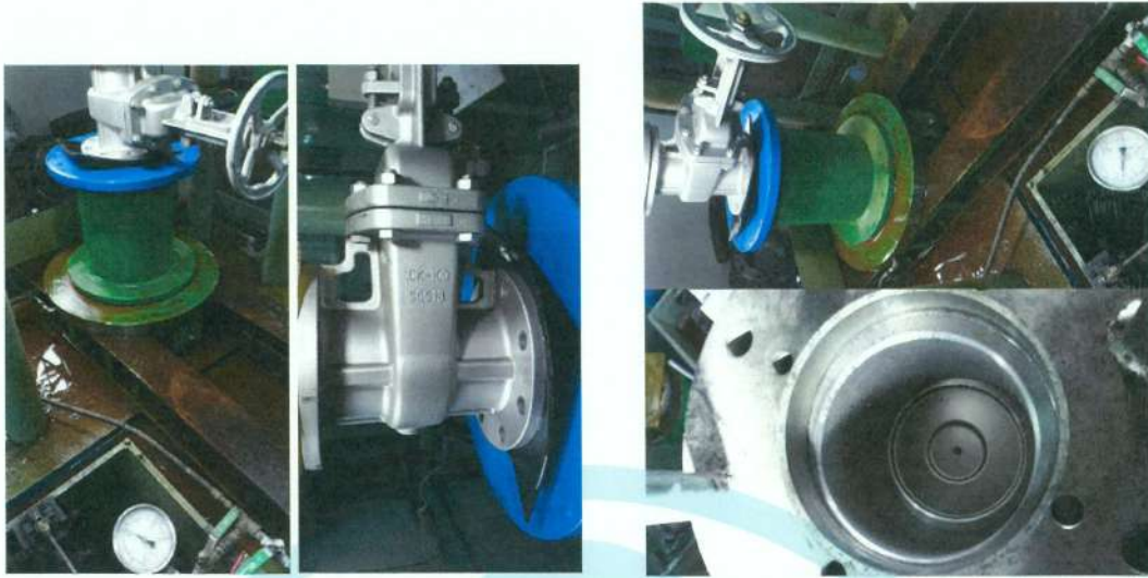
照片 1 法蘭口不銹鋼閘閥 10K (S07 4吋) 閥體及閥座試驗實況
