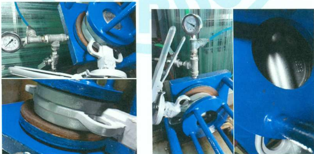
照片 30 夾式鑄鐵蝶閥 10K (F52 4 吋) 閥體及閥座試驗實況
