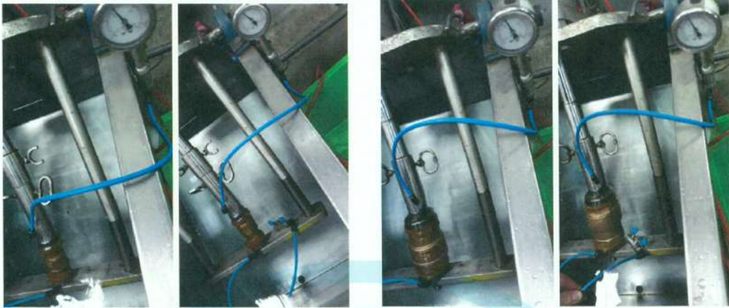
照片 49 螺紋口青銅緩衝逆止閥 (B35 1吋及2吋) 閥體及閥座試驗實況
