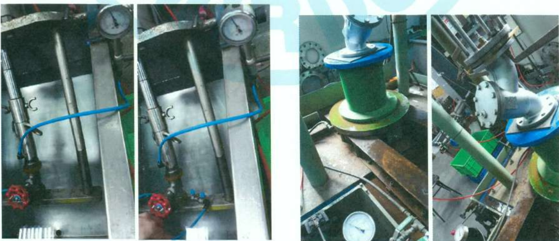
照片 6 螺紋口不銹鋼球型閥 (S12 1 吋) 閥體及閥座試驗實況(左) 法蘭口不銹鋼 Y 型過濾器 (S42 4 吋) 閥體試驗實況(右)
