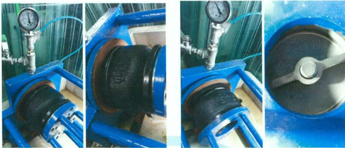
照片 34 夾式鑄鐵緩衝逆止閥 10K (F37 4吋) 閥體及閥座試驗實況
