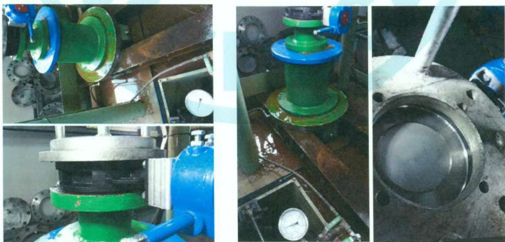
照片 42 延性鑄鐵偏心蝶閥 10K (F54 6 吋) 閥體及閥座試驗實況
