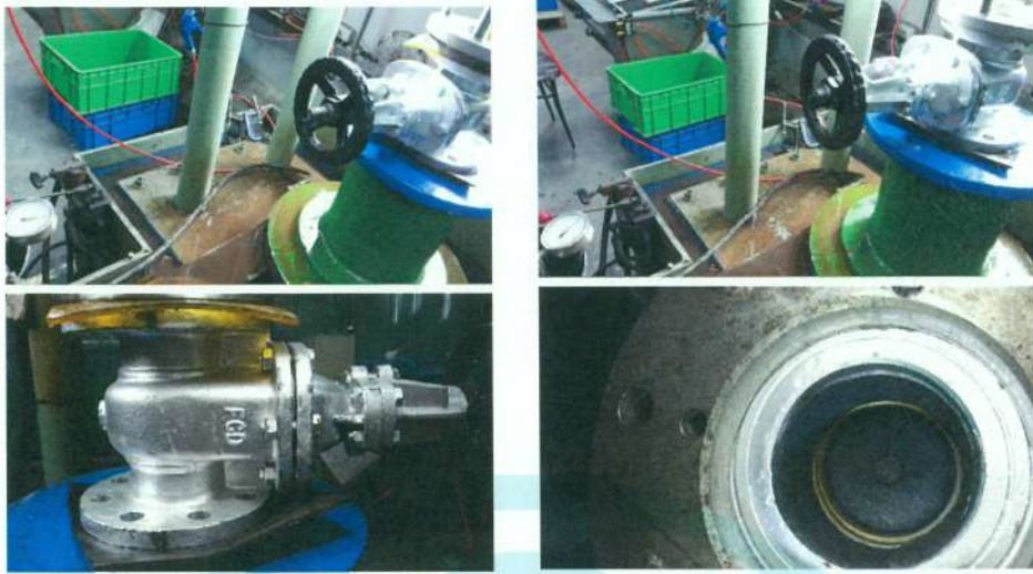
照片 28 延性鑄鐵昇桿閘閥 (D08 3 吋) 閥體及閥座試驗實況
