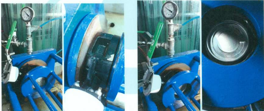
照片 41 延性鑄鐵偏心蝶閥 10K (F54 2-1/2 吋) 閥體及閥座試驗實況
