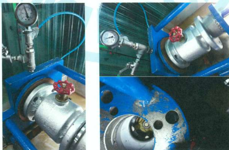
照片 33 法蘭口鑄鐵無聲逆止閥 10K (F36 2 吋) 閥體及閥座試驗實況
