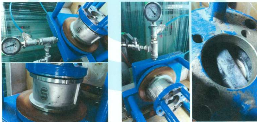
照片 17 不銹鋼雙瓣逆止閥 10K (S38 3吋) 閥體及閥座試驗實況
