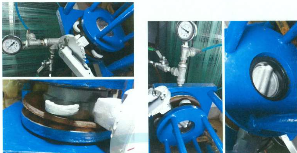
照片 31 夾式鑄鐵蝶閥 10K (F52 2-1/2 吋) 閥體及閥座試驗實況
