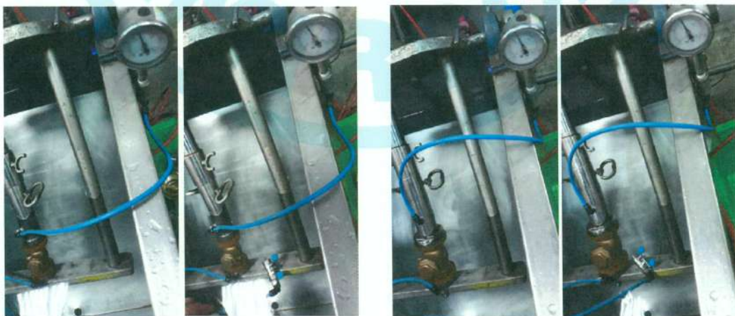
照片 48 螺紋口青銅逆止閥 (B31 3/4吋及 1-1/4吋) 閥體及閥座試驗實況
