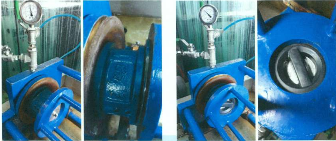
照片 40 鑄鐵雙瓣逆止閥 10K (F38 2-1/2 吋) 閥體及閥座試驗實況
