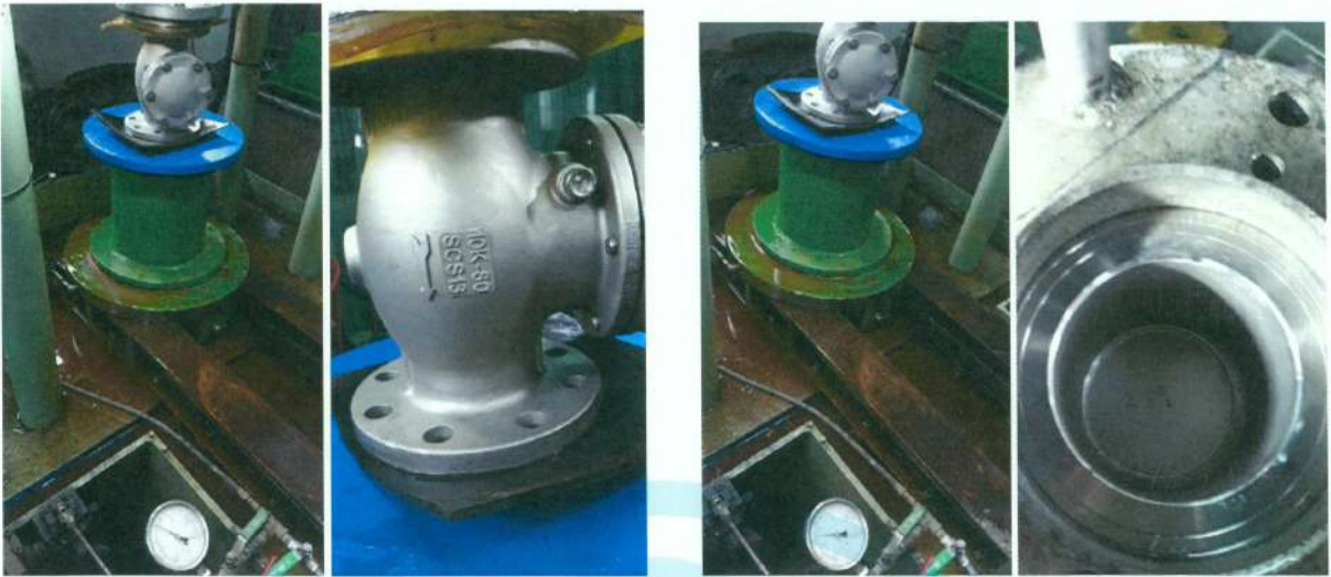
照片 4 法蘭口不銹鋼橫式逆止閥 10K (S33 3 吋) 閥體及閥座試驗實況
