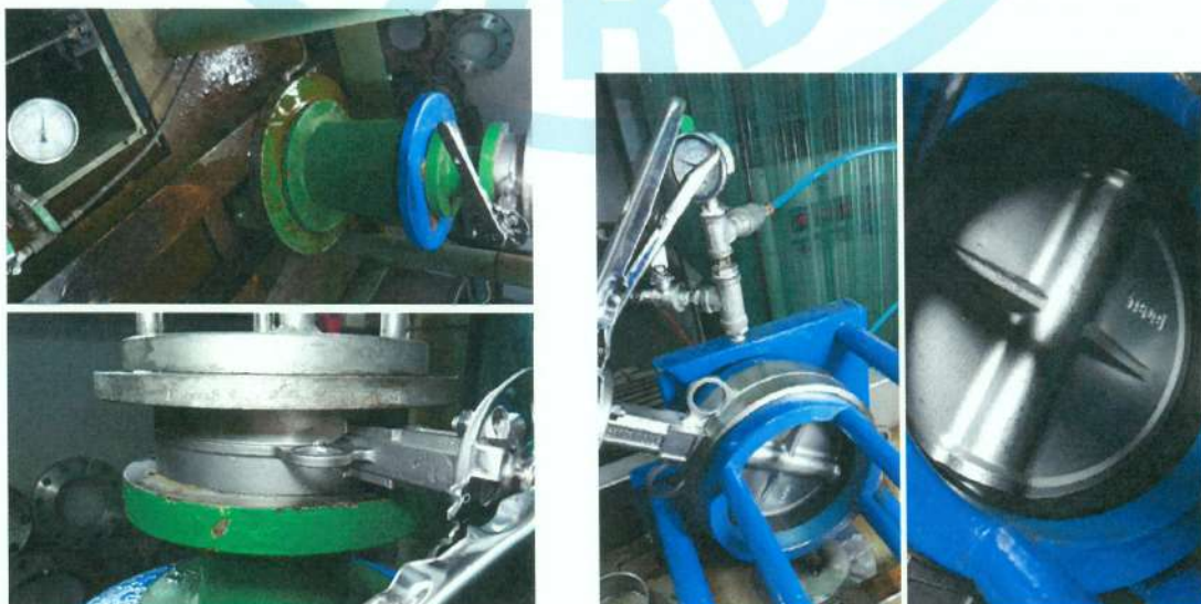
照片 9 夾式不銹鋼蝶閥 10K (S52 6 吋) 閥體及閥座試驗實況
