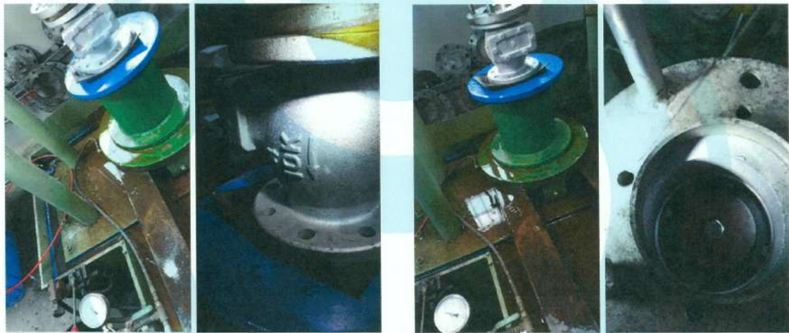
照片 29 法蘭口鑄鐵橫式逆止閥 10K (F33 4 吋) 閥體及閥座試驗實況
