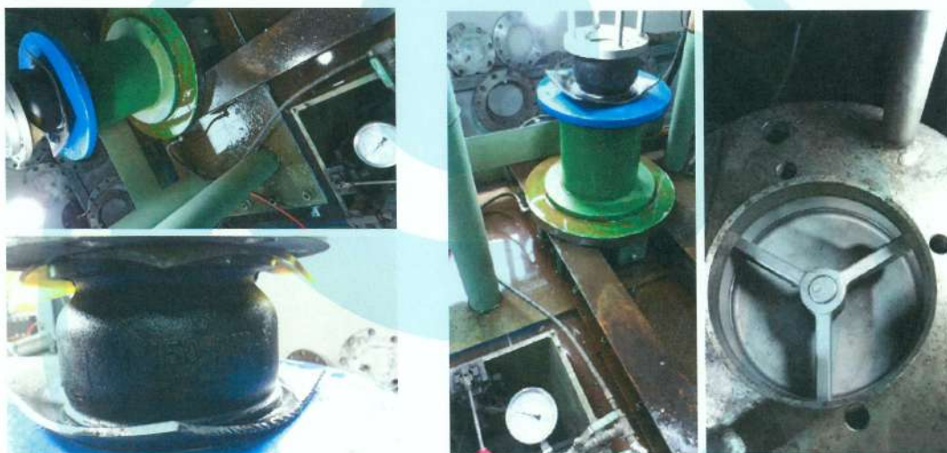
照片 35 夾式鑄鐵緩衝逆止閥 10K (F37 5吋) 閥體及閥座試驗實況
